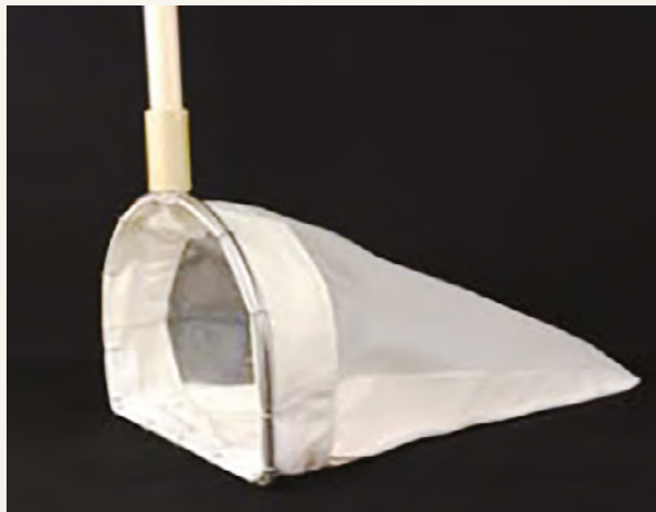
Red tipo "D" para la colección de macroinvertebrados acuáticos en cuerpos hídricos de mayor profundidad (BioQuip Inc 14 )
