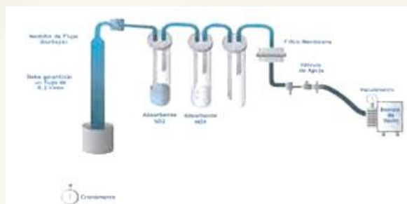
Figura 14. Mecanismo de funcionamiento de un medidor activo burbujeador
