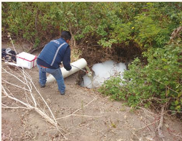
Proceso técnico de levantamiento de una muestra de agua en un sitio en el que se evidenció una descarga directa a un estero proveniente de la planta de tratamiento de aguas residuales. Santa Elena, Santa Elena; febrero 2015
