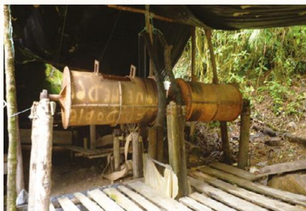
Presencia de dos cilindros amalgamadores (chanchas), con un peso aproximado de 100 Kg c/u y un volumen aproximado de 1,5 m 3 c/u
