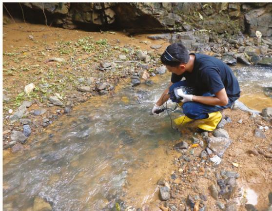
Medición de parámetros in situ por parte de técnico de laboratorio acreditado
