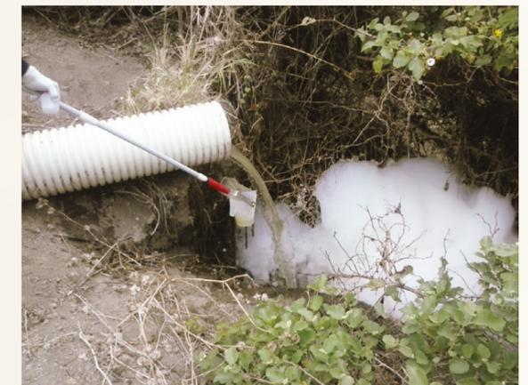
Proceso técnico de levantamiento de una muestra de agua en un sitio en el que se evidenció una descarga directa a un estero proveniente de la planta de tratamiento de aguas residuales. Santa Elena, Santa Elena; febrero 2015
