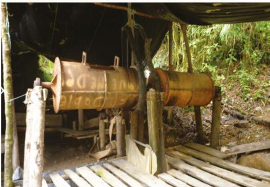
Presencia de dos cilindros amalgamadores (chanchas), con un peso aproximado de 100 Kg c/u y un volumen aproximado de 1,5 m<sup>3</sup> c/u
